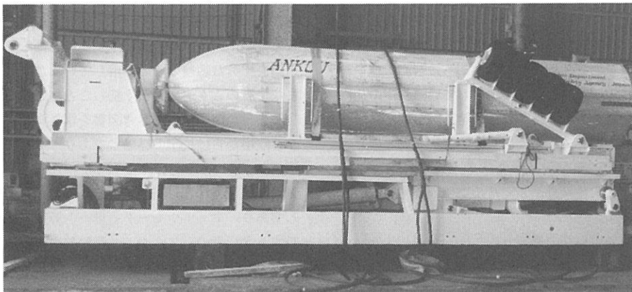
写真2 深海用曳航式サイドスキャンソナー（Sys09） （愛称 アンコウ ANKOU）
