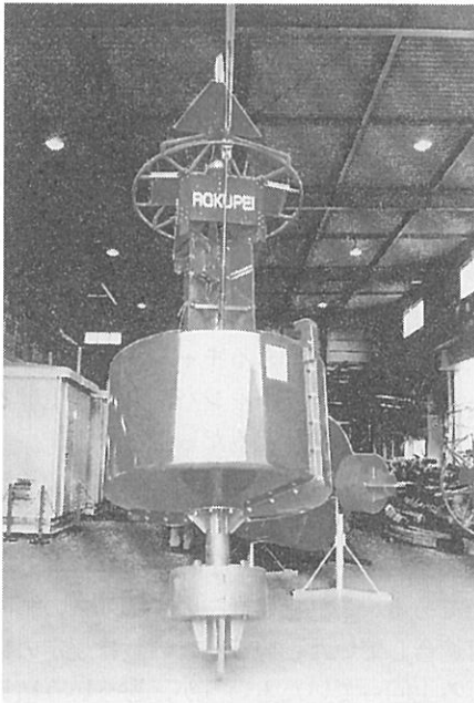
写真9 FRP灯浮標システムS型
