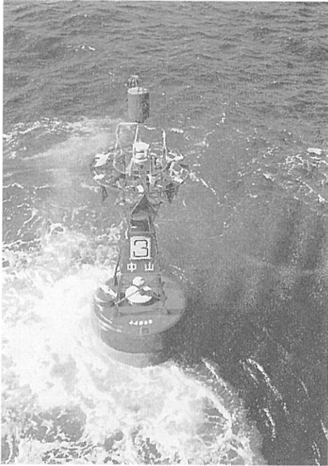
写真1 複合電源(太陽光と波力)を利用した灯浮標 (中山水道第三号灯浮標)
